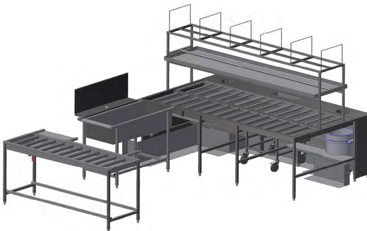
Eksempel på oppvaskanlegg
